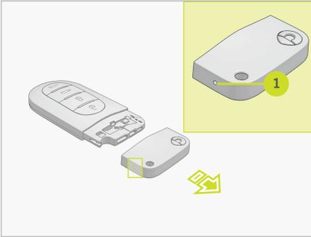
1. Drücken Sie ein geeignetes Werkzeug in das Loch **1** und bauen Sie die Schlüsselanhängerabdeckung in Pfeilrichtung aus.
