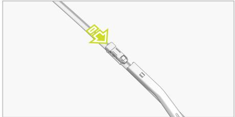
1. Richten Sie ein neues Wischerblatt in Pfeilrichtung am Wischerarm aus und schieben Sie den Clip, bis das Wischerblatt in der Verriegelungsposition festgeklemmt ist.
