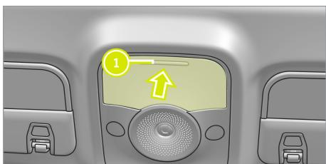
Appuyez sur 1 dans le sens de la flèche pour ouvrir l'étui à lunettes situé au centre de la garniture de toit.
