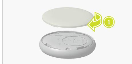
1. Tournez le cache inférieur de la télécommande-clé dans le sens de la flèche **1** et retirez-le.
