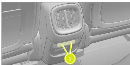
1 Utilisé uniquement pour charger des appareils mobiles, tels que des téléphones portables et des tablettes.
