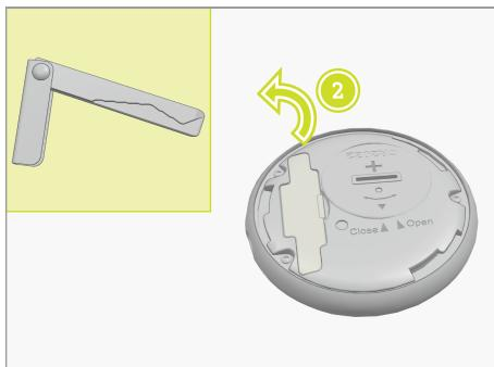
2. Ouvrez le cache de la clé mécanique dans le sens de la flèche **2** et sortez la clé mécanique.
