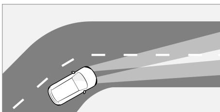
L'éclairage en courbe peut fournir un large éventail d'effets d'éclairage de la voie dans le sens du virage du véhicule, facilitant ainsi la perception de l'état de la route dans la zone de virage.
