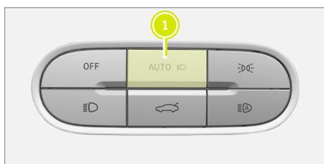
Appuyez sur le bouton 1 de l'interrupteur de combiné d'instruments côté conducteur pour enclencher la fonction automatique des phares.
