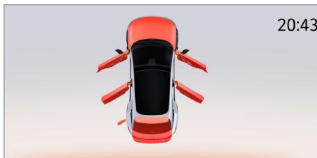
Lorsque le véhicule est sur stationnement **P** / en prise **D** / en marche arrière **R**, si l'une des portes, le capot, le hayon ou le couvercle du port de charge est ouvert, l'indicateur d'état des portes s'affiche en rouge et une alarme retentit pour rappeler au conducteur l'état de la porte correspondante.
