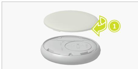
1. Tournez le cache inférieur de la télécommande-clé dans le sens de la flèche et retirez-le.
